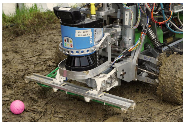
3D-gedrucktes intelligentes Sprühsystem im Einsatz beim FieldRobotEvent
